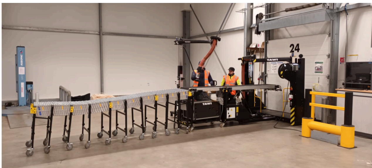
Lors du déchargement, l'utilisation d'un convoyeur télescopique et mobile permet de déporter le problème de la résonance amplifiée.
